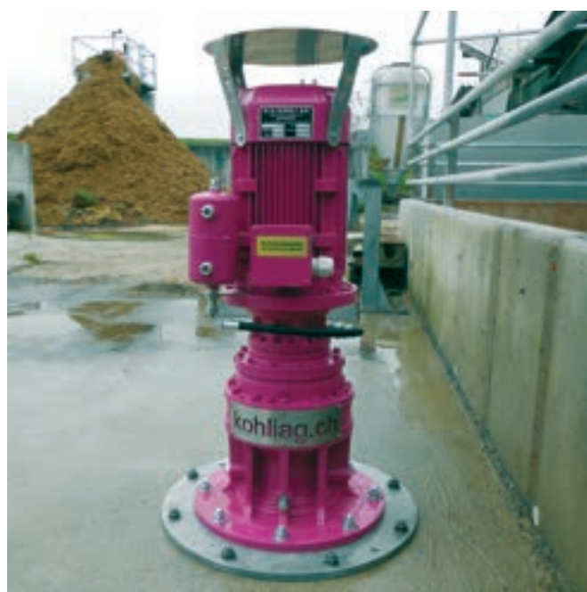
Montato fisso sulla copertura della fossa o su una base in calcestruzzo
