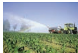
Spandiliquame per distribuzione ad alta pressione
