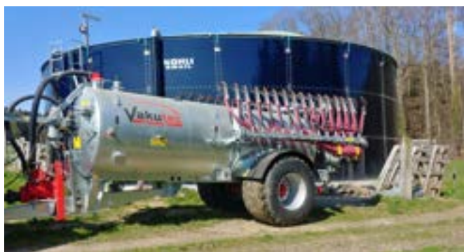
Posizione di trasporto di Starrmax 9 m
