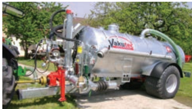
Botte con passaruota incassati
