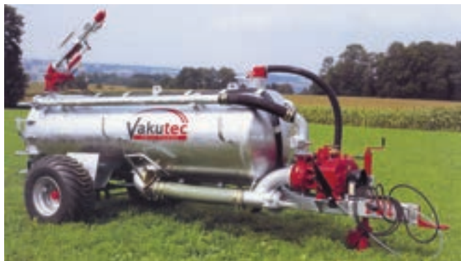
Botte con pompa centrifuga ad alta pressione
