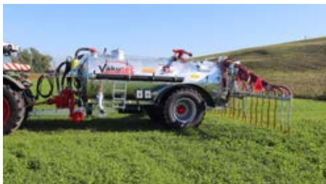
Botte Vakuotec versione combinata da 6500 l con ugello idraulico a lunga gittata Vario, asse regolabile, cupola di riempimento, scala di salita, flusso-metro ecc.
