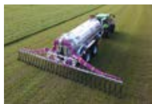
Spargimento di liquame a livello del suolo con Starr-pack S 9 m
