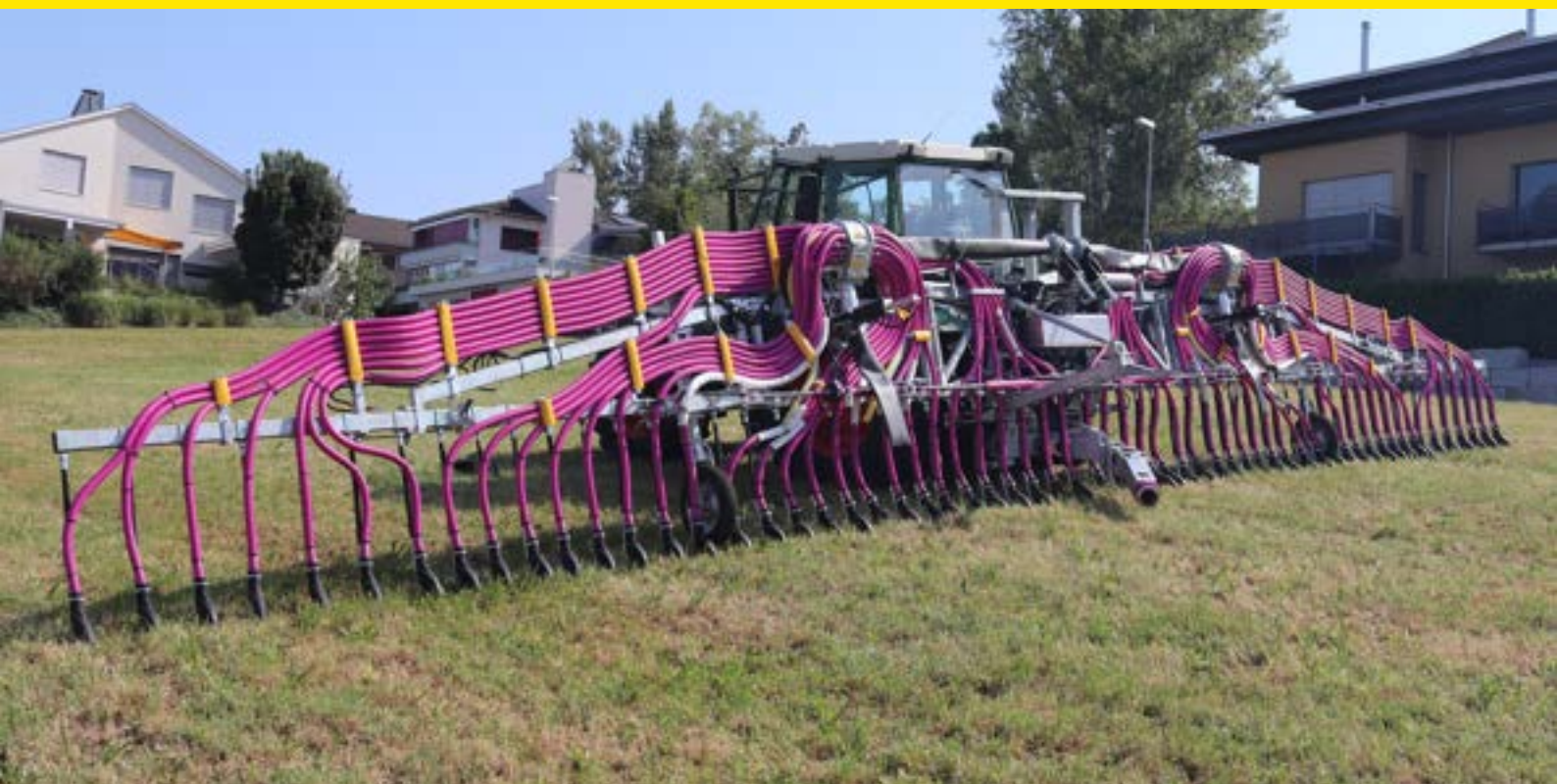
Barra con tubi semirigidi con assolcatore da 15 m in posizione di lavoro
