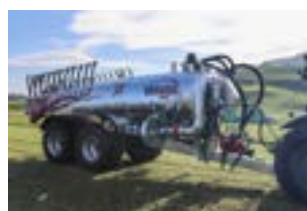
Botte sotto vuoto/tandem da 12'500 l con braccio di aspirazione e acceleratore di carico (combi)
